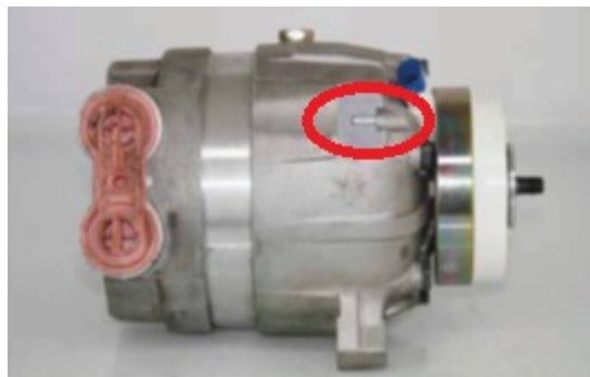
NOSAČ JE OŠTEĆEN
