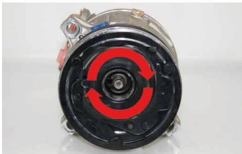
Kuplung tárcsának forognia kell mindkét irányba
