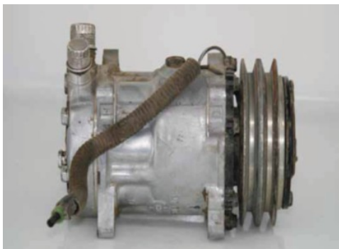
Kuplung tárcsának forognia kell mindkét irányba
