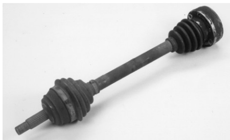
Planetara completa, fara coroziune excesiva.
