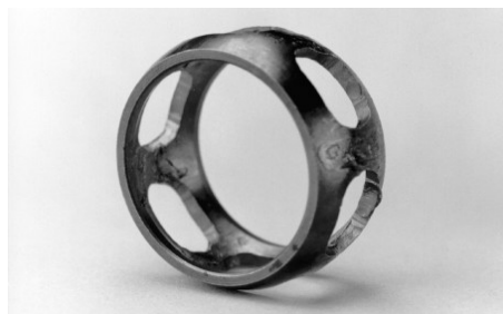
Fara deteriorari cauzate de temperaturi ridicate.
