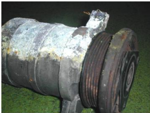
Korozija uništila kućište kompresora
